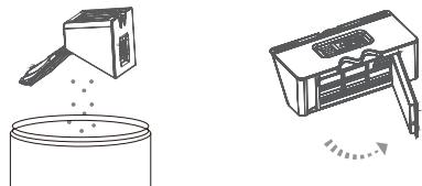
4. Làm sạch hộp bụi, bộ lọc chính và bộ lọc HEPA bằng chổi quét làm sạch. Hộp bụi, bộ lọc chính và bộ lọc HEPA có thể được làm sạch bằng nước.
