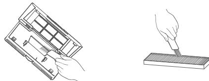
5. Vui lòng làm khô hoàn toàn hộp bụi, bộ lọc chính và bộ lọc HEPA sau khi rửa bằng nước. Lắp đặt hộp bụi vào thiết bị sau khi lắp đặt bộ lọc HEPA.
